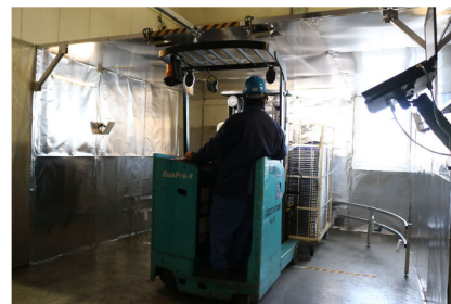
フォークリフトにレンタル品を載せて、一括で読み取ることも可能
